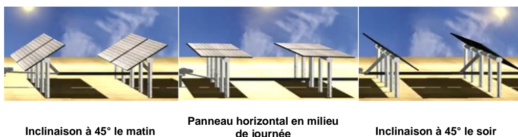
Figure 158 : Fonctionnement des trackers mono-axe (source : EOLFI)
